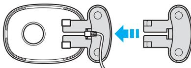
電源コードをブラシスタンドの切れ目に通し、図のように充電器の底にはめ込みます。
