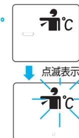
2 わきの場合約10分間、口中の場合約5分間検温します。検温中に温度上昇が少なくなると (0.075°C/30秒以下になると)「ピー」と鳴り、°Cマークが点灯に変わりますが、より正確に検温したいときは、そのまま検温を続けてください。
