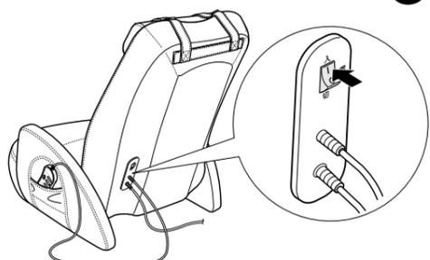
本体の電源が入り、リモコンの主電源ランプが点灯します。
