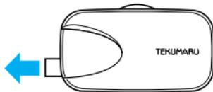
本製品は、工場出荷時に電池の消耗を防ぐため、電池の絶縁をしています。
