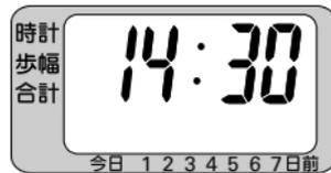
設定が終わったら「表示切換」ボタンを押してください。時刻が確定し、歩幅設定に移ります。
