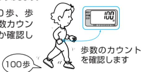
実際の歩数とカウントに誤差があったときは、P12「感度調整のしかた」を参照して調整してください。
